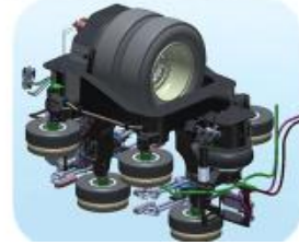
龐巴迪轉向架結構形式 Bogie structure type of Bombardier
