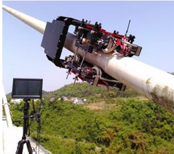
圖三 吊索機器人可進行監測、維修及安全巡視。 (DYWIDAG 提供)
