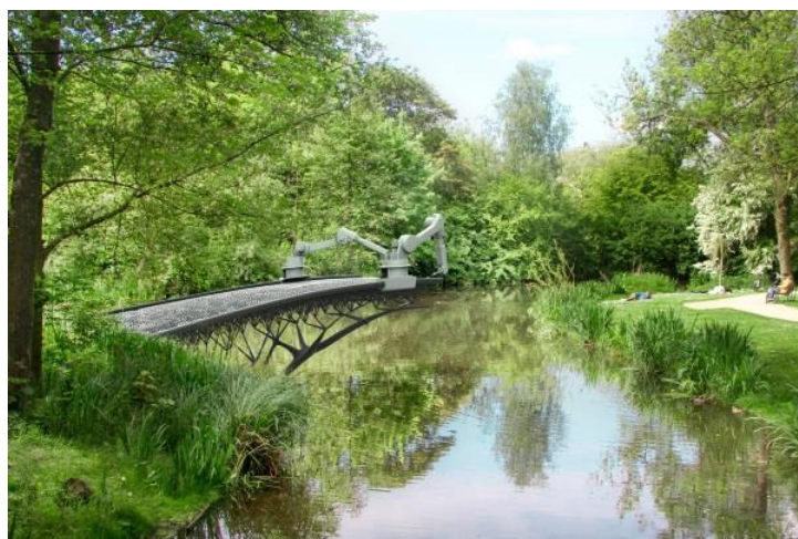
圖一 荷蘭 3D 列印人行橋 (參考 MX3D 網站)
