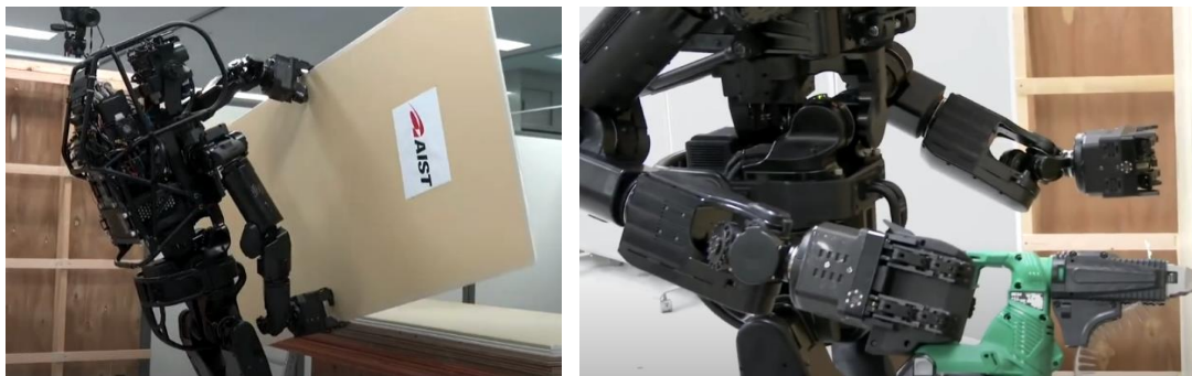
圖四 人形機器人進行辦公室隔間施工作業。 (參考 https://www.youtube.com/watch?v=2fmRejSRkss )
